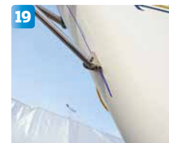
19 Ett streck exakt i fören gör det lättare att få hålen på rätt ställe.
