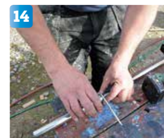
14 Stången består av två delar där den ena går inuti den andra.
