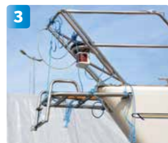
3 Peket ska sitta rakt i alla led. Möjligtvis kan det vara lättare att rikta in det när båten ligger i sjön under förutsättning att båten är jämnt stuvad.
