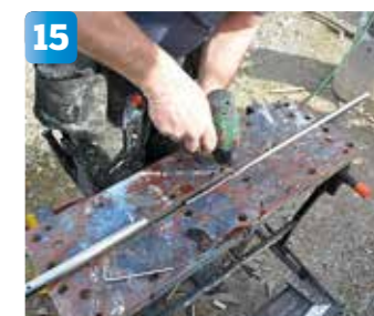
15 Ett 8,5 mm hål ska borras i det inre röret...
