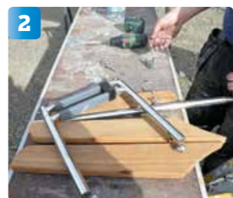
2 För att underlätta monteringen demonterade vi först teaken och stegen på det nya peket.
