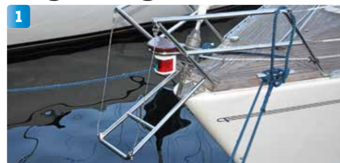
1 I original satt en snillrik steg infälld i pulpiten på båten. Tyvärr fungerade den aldrig riktigt bra och det var ett rent elände att komma ombord. Ett peke borde vara lösningen på problemen.
