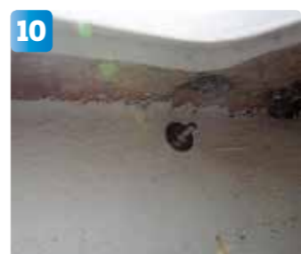
10 Peket fästs på insidan med genomgående skruvar. Två på varje sida för infästningen och två i fören för det stöttande röret.
